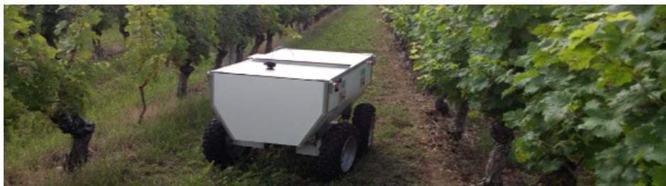
Réalisation d'un robot autonome de mesure de la qualité du raisin
