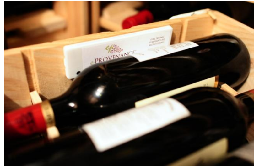
Capteur 2nd Génération : température et hygrométrie batterie de 15 ans, lisible par un Smartphone NFC
